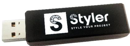
Zur Programmierung der DOMINOSWISS-Komponenten ist der STYLER USB-Dongle notwendig. Bitte verbinden Sie den STYLER USB-Dongle bevor Sie die STYLER Windows App öffnen. Es wird dabei auch der korrekte Treiber für den USB-Dongle installiert.
